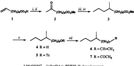
*i*) MeOH/H<sup>+</sup>, *ii*) Hg(OAc)<sub>2</sub>/THF/H<sub>2</sub>O, Jones' reagent *iii*) n-C<sub>3</sub>H<sub>7</sub>PPh<sub>3</sub>Br/Dimsyl, *iv*) H<sub>2</sub>/10% Pd-C, *v*) LAH *vi*) p-TsCl/Py, *vii*) KOBu<sup>t</sup>/DMSO/ $\Delta$
